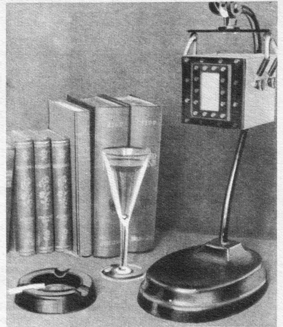
Das fertige Bändchenmikrophon in einem Stuhlampenständer aufgehängt. Das Ganze ein Stück, auf das der fortschrittliche Bafler stolz sein darf.
